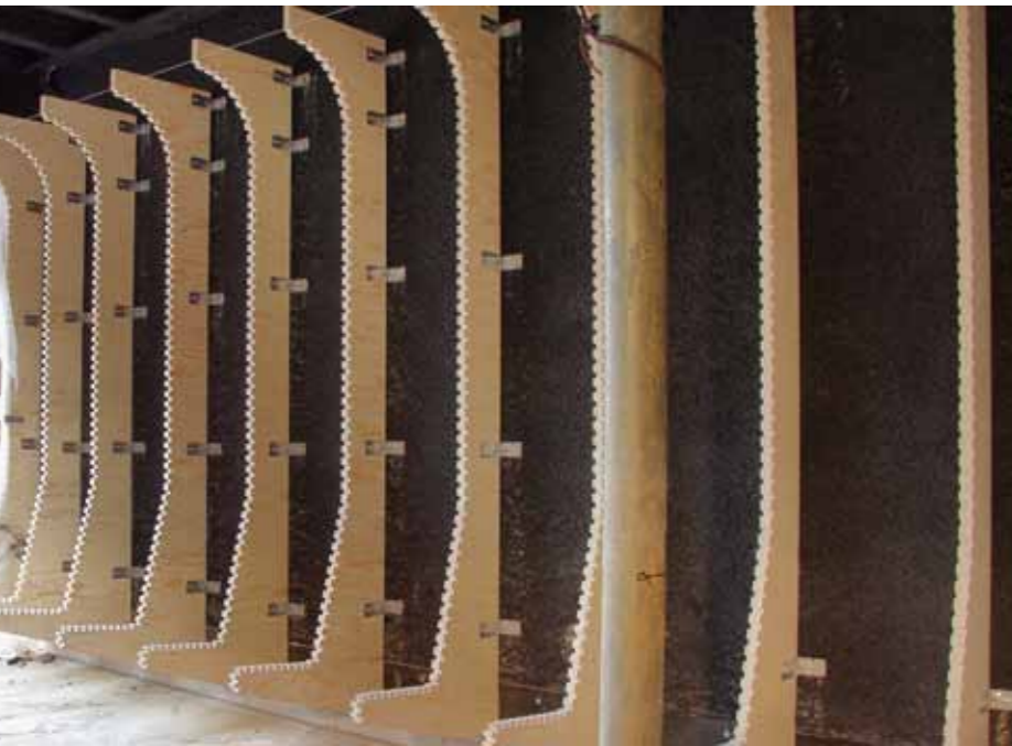
Met grote precisie zijn de inkepingen voor de lamellen in de schenkels gefreesd.
